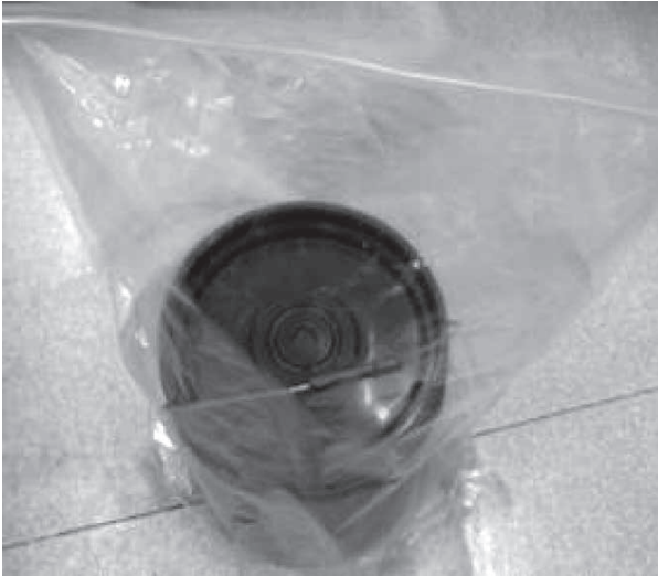
図8 問題事例③以後の臓器固定用バケツ 特殊フィルム構造の袋により、ホルムアルデヒドガスを内側から閉じ込める。
