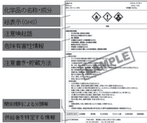
図 5 a 化学物質データシート (SDS) 化学品の成分や有害性情報、漏出時対応などが載っている。
